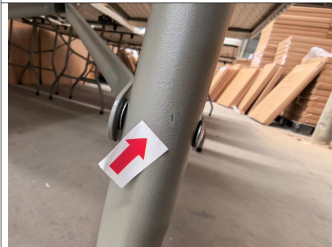
油漆破损-轻微
