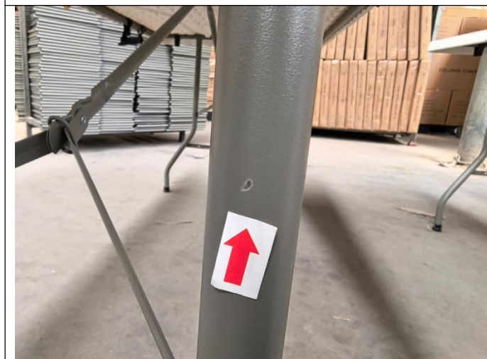
油漆破损-轻微
