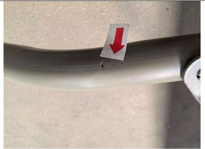
铁管轻微破损-轻微
