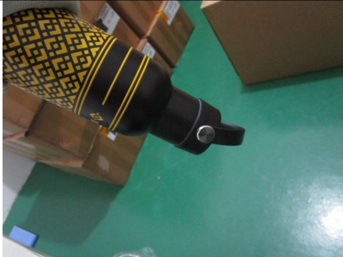
功能检查 防漏水
