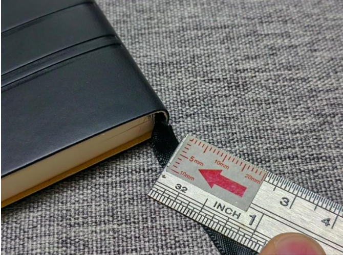
便签丝带破损-严重缺陷
