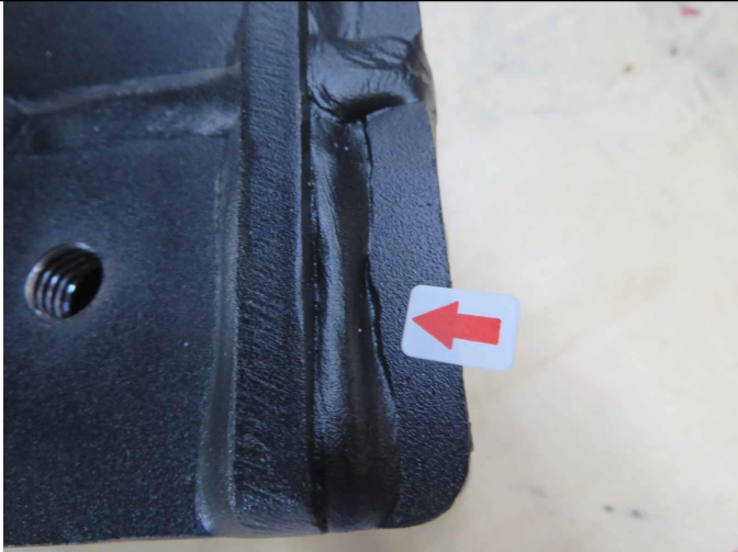
焊缝表面咬边-严重
