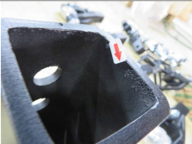
方形管切割后留下的氧化铁未清理干净-轻微
