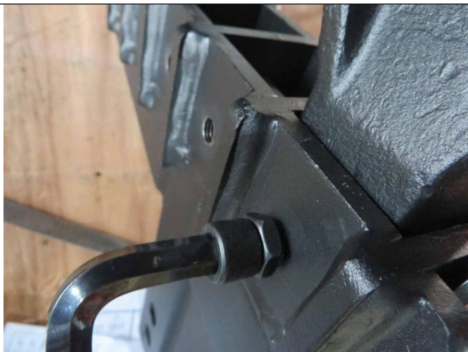
锁紧螺母紧固后可以消除晃动
