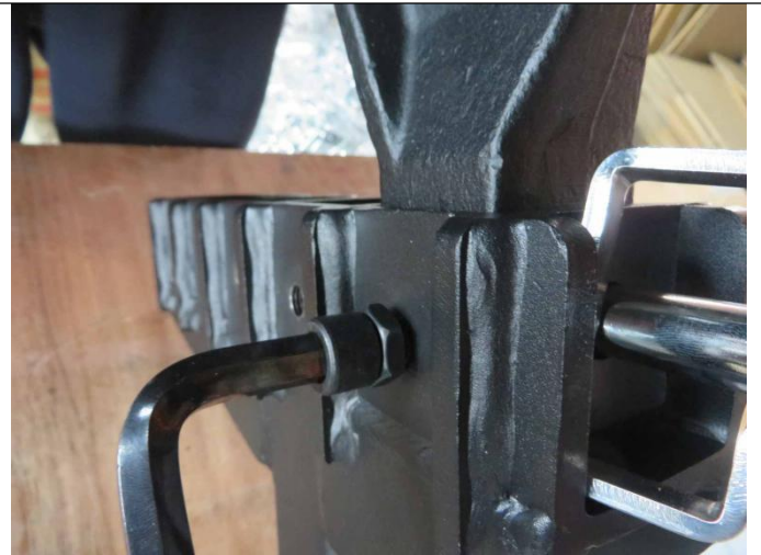
锁紧螺母紧固后可以消除晃动
