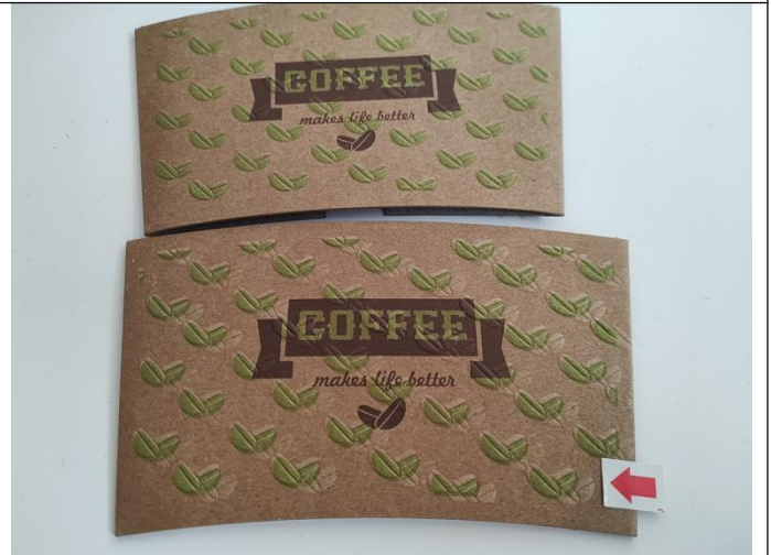
压纹错位-严重
