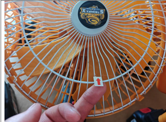
Paint peeling - Maj
