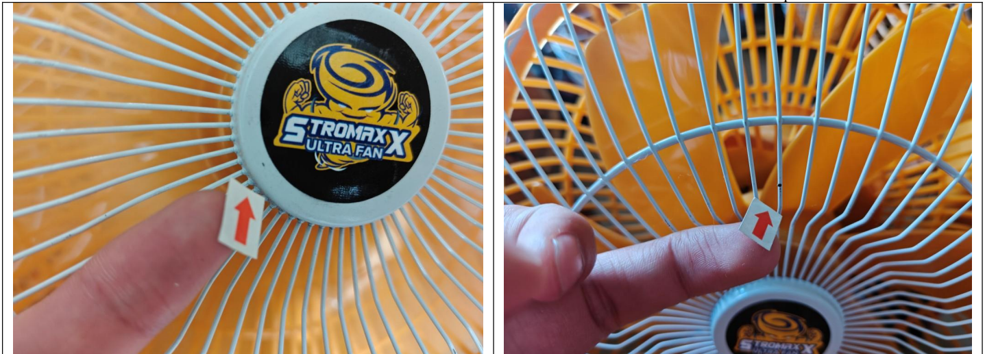
Paint peeling - Maj
