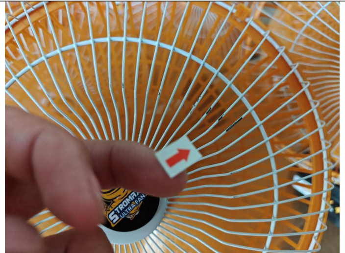
Paint peeling - Maj
