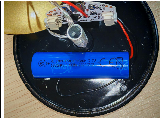
SVD0501 电池已喷码, 型号, 容量等信息齐全
