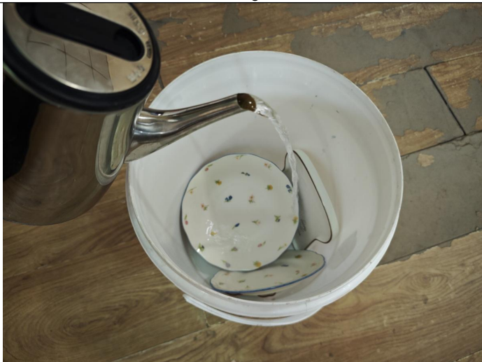
Thermal shock test
