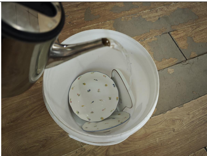
Thermal shock test
