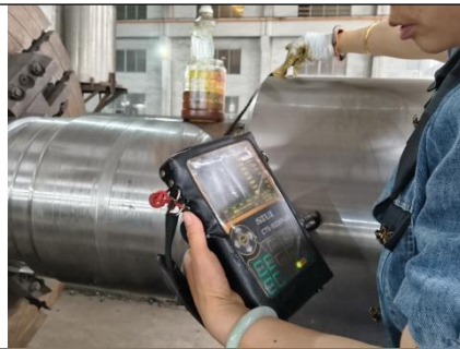
Pic.158 UT Test
